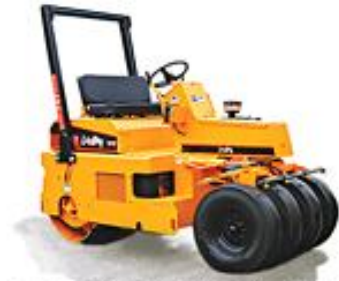
غلتک پنوماتیک با قابلیت تغییر فشار باد لاستیک
