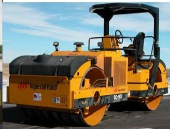
غلتک چرخ لاستیکی ارتعاشی (سمت چپ) و غلتک چرخ آهنی صاف ارتعاشی (سمت راست)
