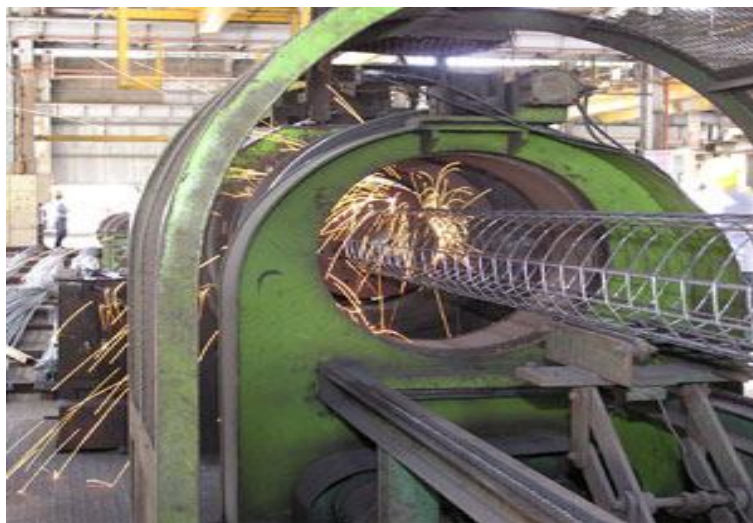
شکل ۱۰_۴: برش قفسه آرماتور در ابعاد مختلف
