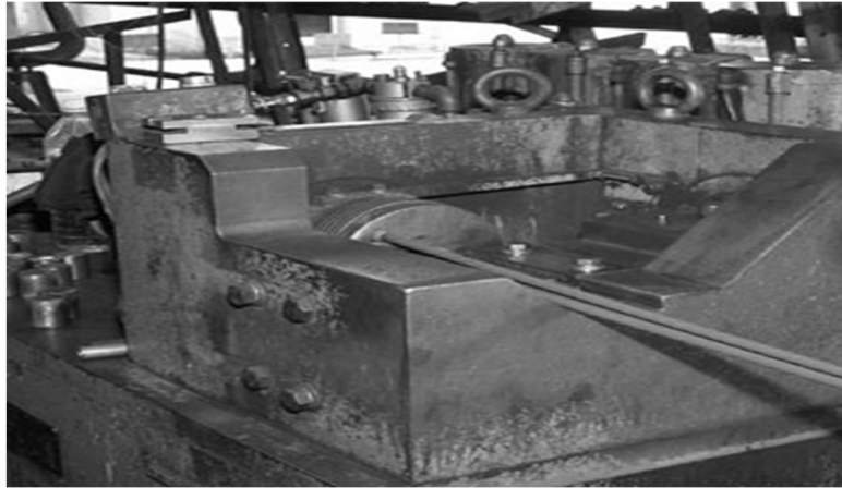
شکل ۱۰_۲: تغییر شکل انتهایی آرماتورهای پیش تنیدگی
