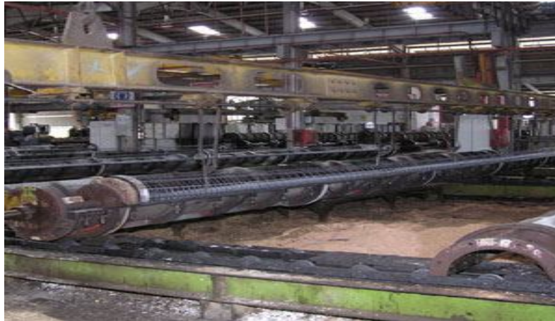
شکل ۱۰_۷: قراردادن قفسه آرماتور در نیمه قالب
